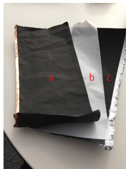
Abbildung 3 – Anoden-(a), Separator-(b), Kathoden(c)-Material
