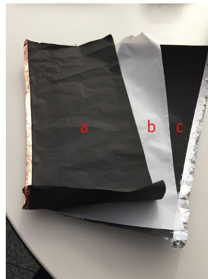
Abbildung 3 – Anoden-(a), Separator-(b), Kathoden(c)-Material
