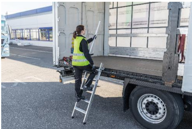
Abbildung 5 – Aufstiegsleiter Magnetisch fixiert, ausziehbarer Handlauf
