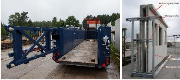
Abbildung 9a und 9b – Transportsystem Innenlader und Innenlader-Palette Erleichterte Ladungs- und Bauteilsicherung
