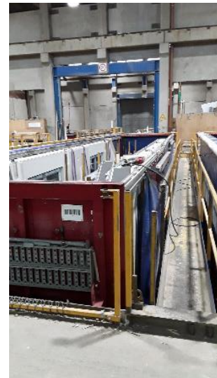
Abbildung 17 – Laufstege im Verladebereich Keine Absturzgefahr durch Seitenschutz
