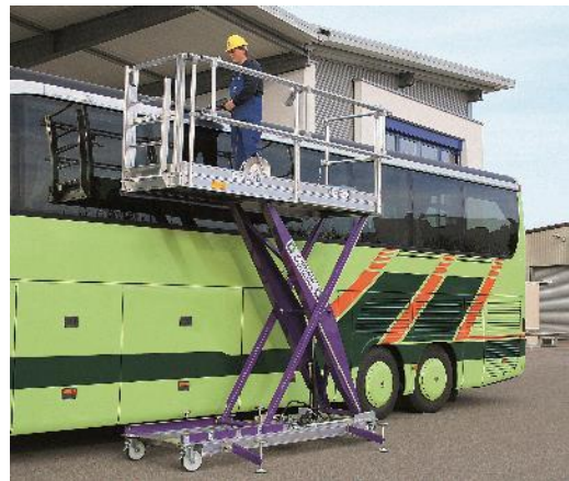
Abbildung 4 – Mobile Arbeitsbühne Höhenverstellbarer Zugang und Arbeitsplatz mit Absturzsicherung (branchenübergreifend)
