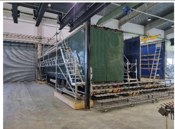
Abbildung 8 – Treppenzugang im Verladebereich Fester Zugang zur Ladefläche des Sattelauflegers
