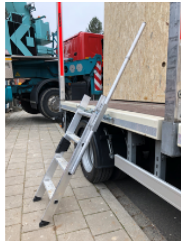
Abbildung 32 – Aufstiegsleiter Fahrzeug Sicherer Zugang auf Ladefläche, mit ausziehbarem Handlauf, am Fahrzeug befestigt
