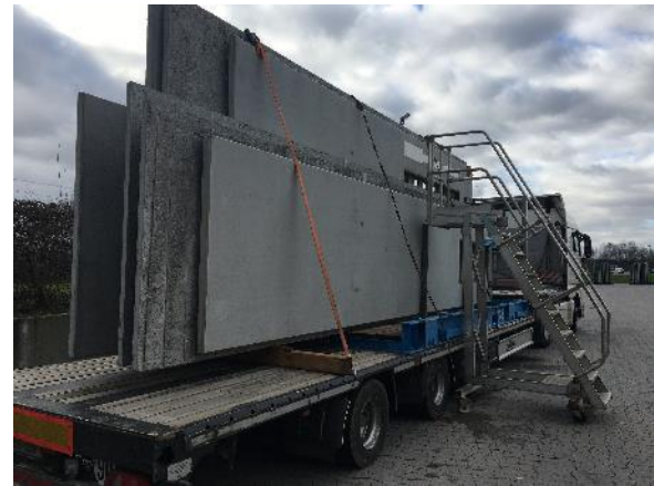
Abbildung 21 – Podestleiter/Plattformleiter Sicherer Arbeitsplatz durch Plattform/Podest, verfahrbar
