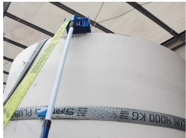
Abbildung 25 – Hilfsmittel zum Platzieren der Ladungssicherung Bodennahes Ausrichten und Platzieren z. B. der Spanngurte, Kantengleiter (branchenübergreifend)
