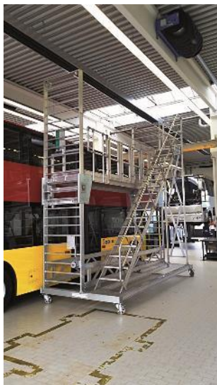
Abbildung 24 – Höhenverstellbare Dacharbeitsbühne Geländer kann über dem Fahrzeug ausgeklappt werden (branchenübergreifend).
