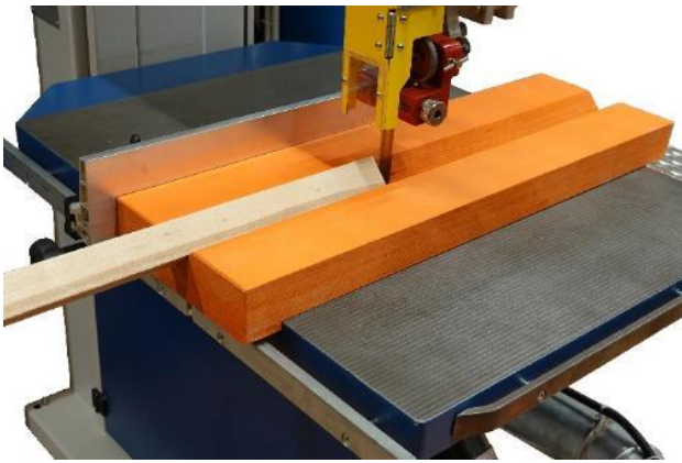
Abbildung 19 – Lade für kippende Werkstücke
