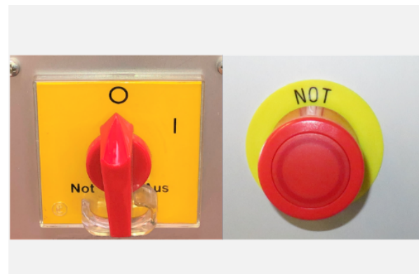
Abbildung 3 – Beispiele für Stellteile, links ältere Ausführung eines Not-Aus-Schalters, rechts eine Not-Halt-Befehlseinrichtung
