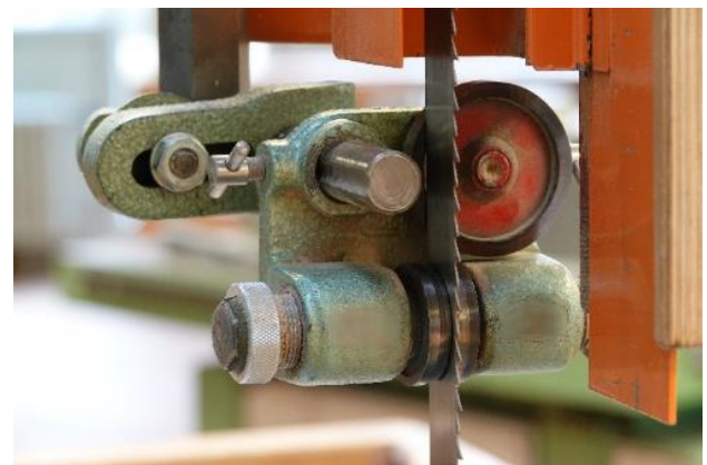
Abbildung 13 – Obere Sägeblattführung, rückseitige und seitliche Führung des Bandsägeblattes über „Rollen“
