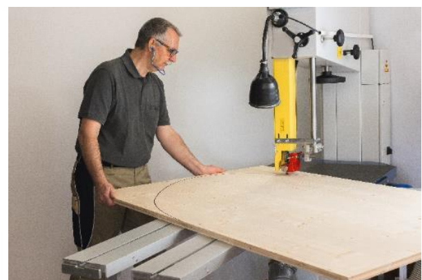
Abbildung 5 – Beispiel für eine Tischverbreiterung/-verlängerung für längere und breitere Werkstücke
