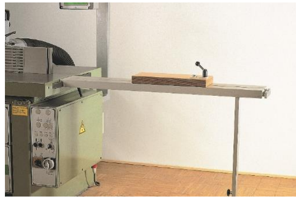
Abbildung 19 – Queranschlag auf einer Tischverlängerung für längere Werkstücke eingestellt
