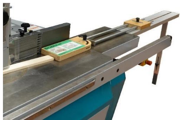
Abbildung 20 – Beispiel für Queranschlag an einem überlangen Tisch
