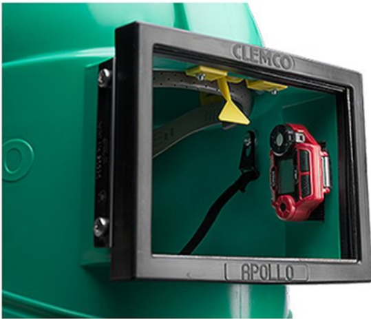
Abbildung 6 – Strahlschutzhaube mit Warn-einrichtung (ausklappbare Fahne bei zu geringem Volumenstrom (gelb) und CO-Warn-gerät (rot) mit optischer und akustischer Warnung)
