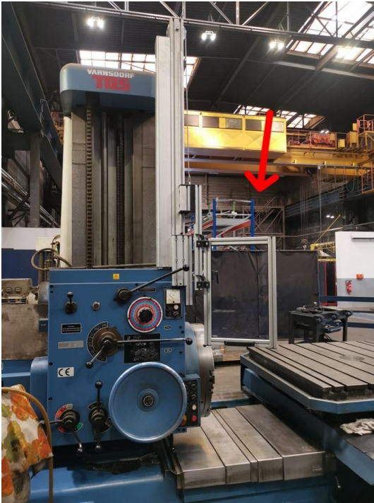
Abbildung 2 – Handgesteuertes Universalbohrwerk mit vertikal einstellbarer Schutzeinrichtung
