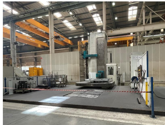
Abbildung 1 – Großzerspanungsmaschinen mit allseitiger Zugangsabsicherung und gesichertem Bedienstand. Im vorderen Bereich gesichert durch Lichtschranken, das Absperrband ist nur ein Hinweis, um ein zufälliges Betreten des Maschinenraumes zu verhindern.
