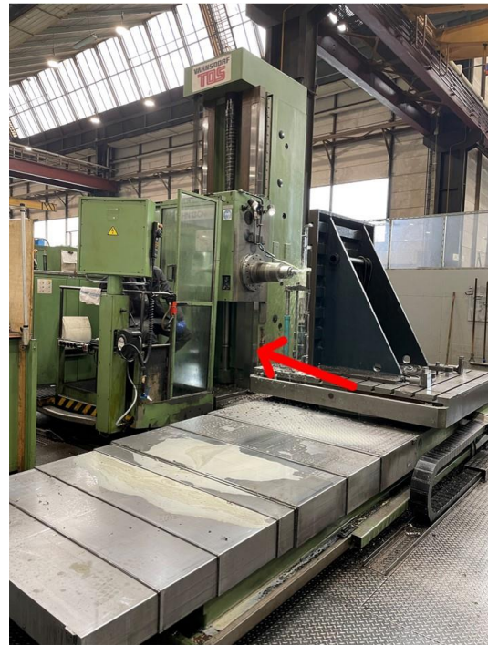
Abbildung 3 – Numerisch gesteuertes Universalbohrwerk mit verriegelten, beweglichen trennenden Schutzeinrichtungen am Bedienstand
