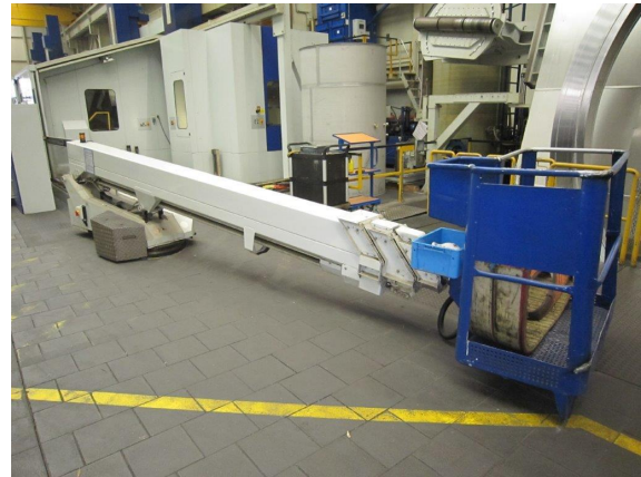
Abbildung 7 – Gesicherter Stand zum Erreichen von Einstellplätzen in Höhe
