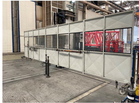
Abbildung 5 – Großzerspanungsmaschine mit Zugangsabsicherung durch eine bewegliche Stellwand, die in ihre Position steuerungs-technisch verriegelt werden kann.
