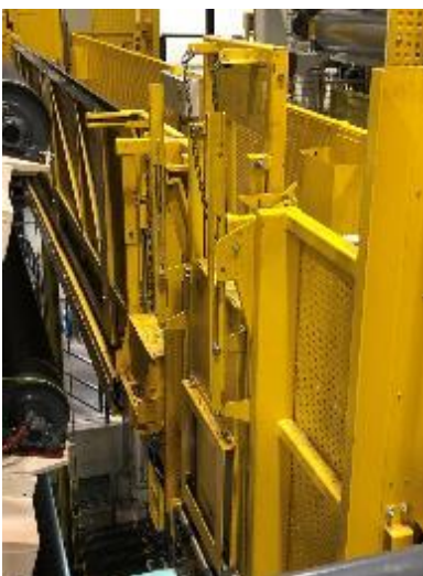
Abbildung 39 – Hubarbeitsbühne mit eingefahrener Walzenwechselbühne
