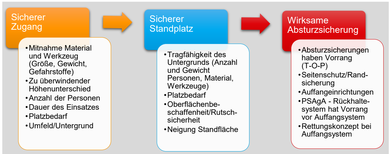
Abbildung 2 – Ganzheitliche Betrachtung eines hochgelegenen Arbeitsplatzes
