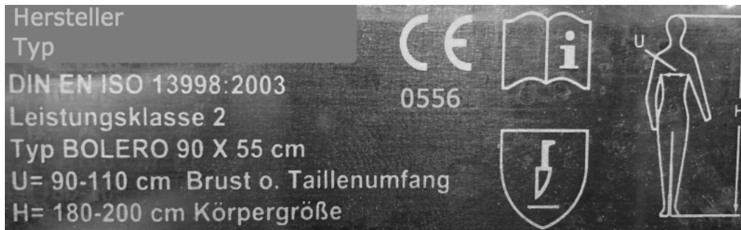
Bild 3: Beispiel für die Kennzeichnung von Stechschutz-Kleidung Kat. III incl. Prüfnorm, Leistungsklasse (hier: 2 = Stechschutz + Stechschutz-Piktogramm), PSA-Abmessungen, Größe des Anwenders/der Anwenderin, CE-Kennzeichen und Hinweis auf weitere Infos in der Verpackung
