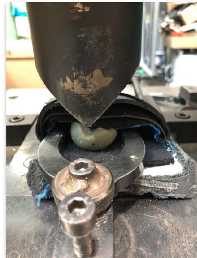
Abbildung 3: Prüfung Resthöhe unter der Zehenkappe – Zerstörungsprüfung
