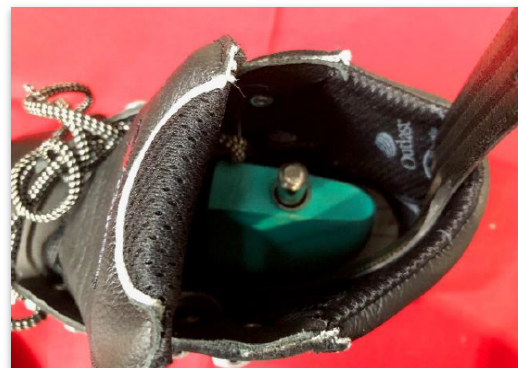
Abbildung 2: Prüfung Energieaufnahmevermögen im Fersenbereich
