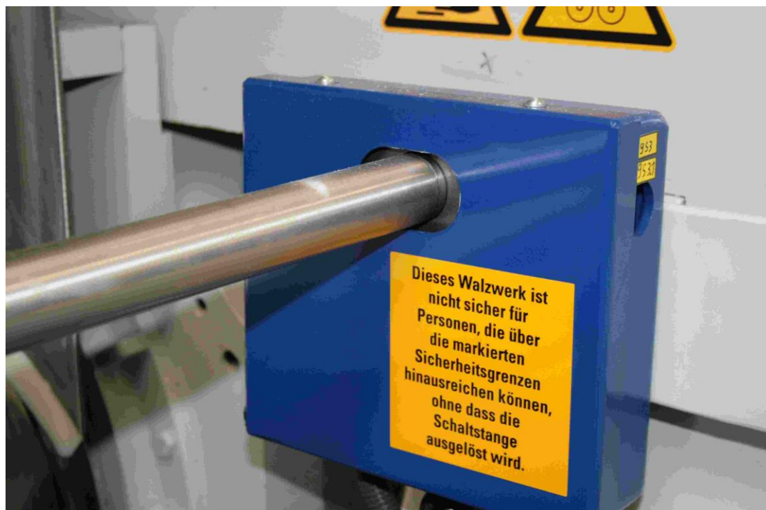
Bild 4: Manipulation durch Festklemmen der Schaltstange leicht möglich
