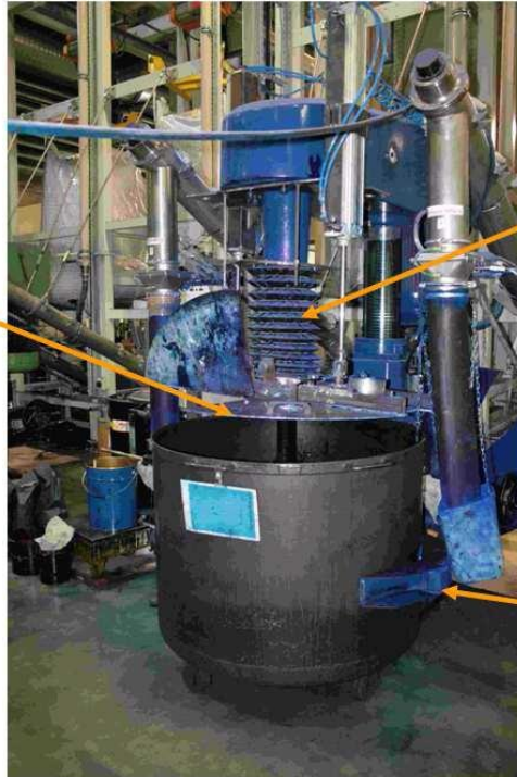
Bild 2: Schutzeinrichtungen für die Rührwelle und das Rührorgan
