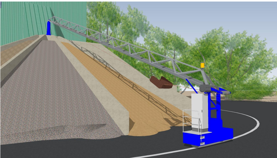
Abbildung 3 – Sternanlage mit Schrapperbrücke
