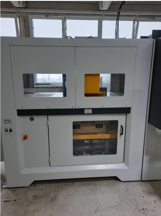
Bild 2: Verriegelte Türen an der automatisierten Plattenzufuhr
