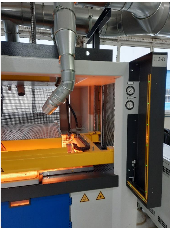
Bild 3: Bedienseite mit sensibler Schutzeinrichtung („Lichtvorhang“)
