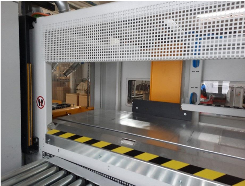
Bild 4: Austragsseite mit sensibler Schutzeinrichtung („Lichtvorhang“)
