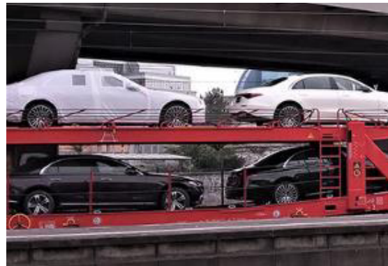
Abbildung 4: Autotransportwagen mit heruntergeklappter Absturzsicherung während der Fahrt
