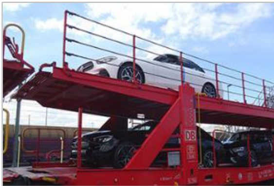
Abbildung 3: Autotransportwagen mit aufgestellter Absturzsicherung während der Be- oder Entladung
