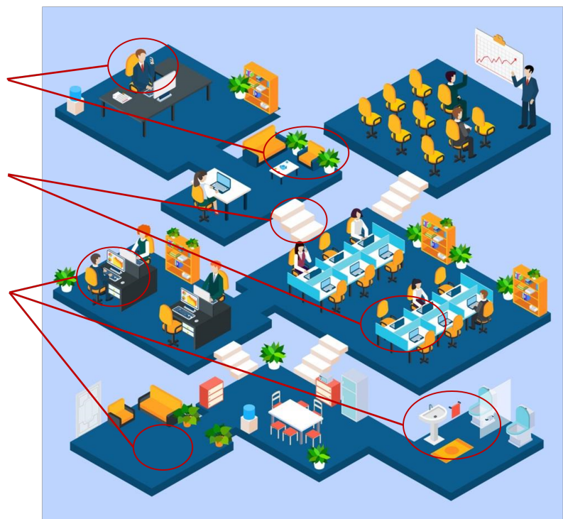
Abbildung 1 – Beeinflussung der Innenraumluftqualität durch Quellen im Innenraum und aus der Außenluft am Beispiel von Büroarbeitsplätzen.
