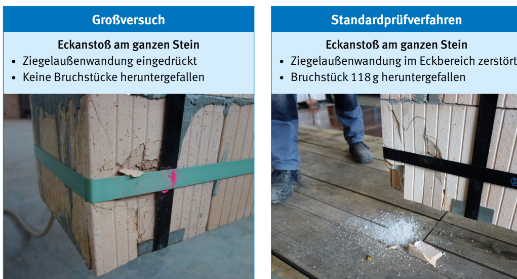
Abb. 31 Beispiel für Ergebnisse aus 2 Eckanstoßen am ganzen Stein (Wand 1)
