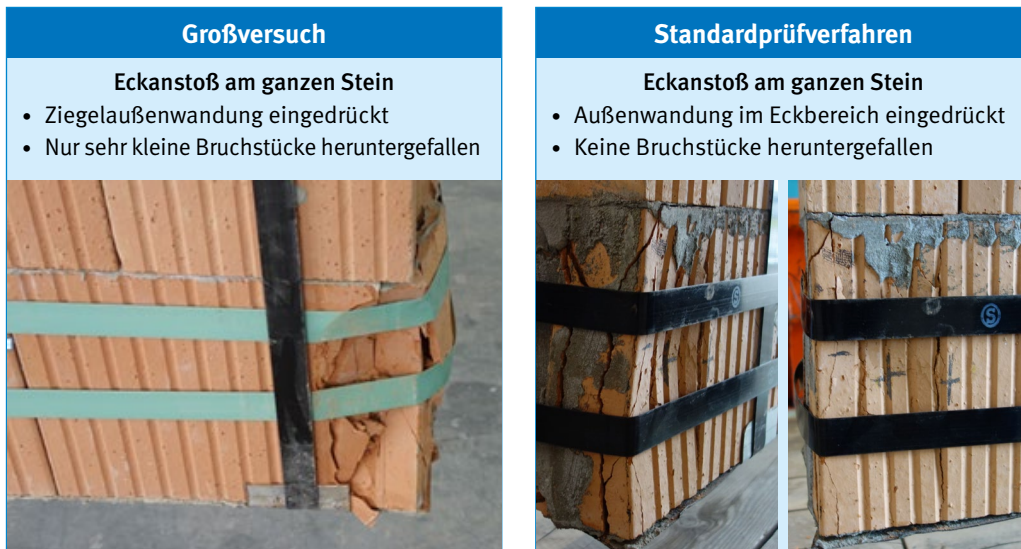
Abb. 33 Beispiel für Ergebnisse aus 2 Eckanstößen am ganzen Stein (Wand 2)
