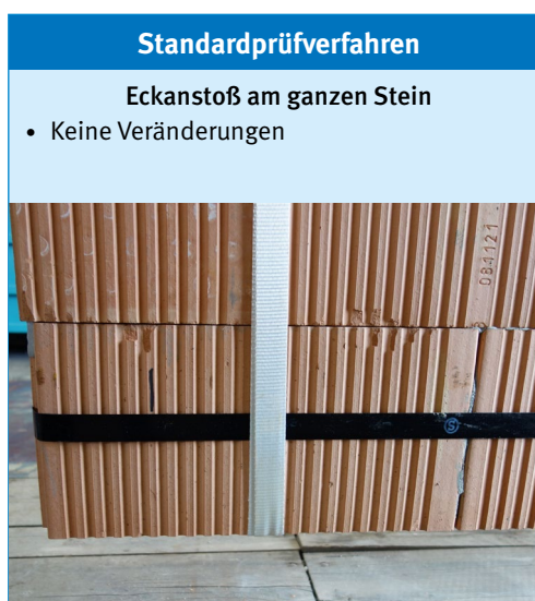
Abb. 35 Beispiel für Ergebnisse aus 2 Eckenstößen am ganzen Stein (Wand 3)
