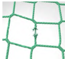
Abb. 9 Sichtprüfung des Netzes (Anmerkung: Linke kleine Abbildung zeigt zerstörte Maschen, rechte kleine Abbildung den Abrieb an der Masche)
