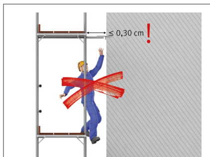
Auf mögliche Absturzgefahr zwischen Gerüst und Gebäude achten
