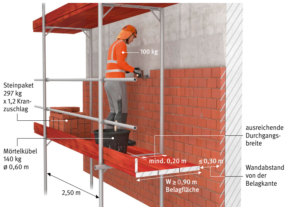
Abb. 13 Beispiel für ein Arbeitsgerüst der Lastklasse 4 und Breitenklasse W09
