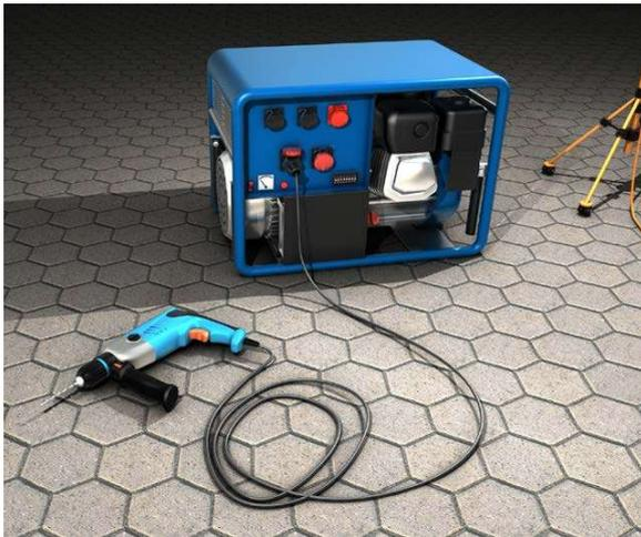
**Abb. 2** Einzelnes Betriebsmittel, direkt am Stromerzeuger angeschlossen
