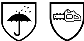
Abb. 4 Piktogramme zur Kennzeichnung von Kleidung zum Schutz gegen Regen (links) und Ketten-sägenschnitte (rechts)
