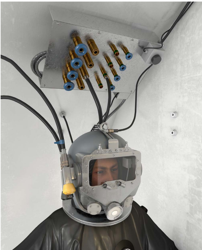
Abb. 17 Zertifizierte Tauchausrüstung für Taucharbeiten in Bentonitsuspension
