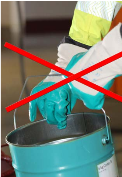
Abb. 8 So nicht! Epoxidharz nicht mit nitrilgetränkten Baumwollhandschuhen verarbeiten!
