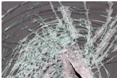
Abb. 6 VSG schützt vor Verletzungen durch Binden der Glasstücke bei Bruch.
