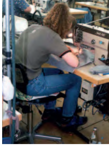
Abb. 7c, d und e: Negativbeispiele – Aufnahmen von Näherinnen: stark vorgebeugte bzw. gekrümmte und verdrehte Haltung des Oberkörpers, da die Tischhöhe zu niedrig und die Fußschalter nicht weit genug nach vorne unter dem Tisch angebracht sind.
