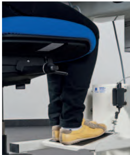
Abb. 17: Mobiler, höhenverstellbarer Fußschalter mit geneigter Trittplatte für Nähen im Sitzen
