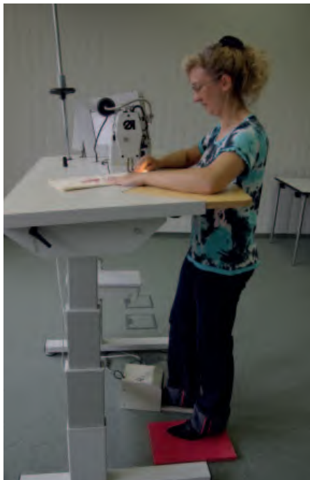
Abb. 5: Geneigte Tischplatte mit Armauflagen rechts oben: günstige Arbeitsposition rechts unten: gute Einsehbarkeit
