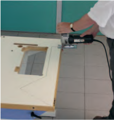
Abb. 30: Tischplatte aussägen (für linke Armauflage mit schrägen Schnittachsen)
