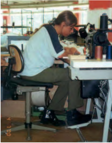
Abb. 7c, d und e: Negativbeispiele – Aufnahmen von Näherinnen: stark vorgebeugte bzw. gekrümmte und verdrehte Haltung des Oberkörpers, da die Tischhöhe zu niedrig und die Fußschalter nicht weit genug nach vorne unter dem Tisch angebracht sind.
