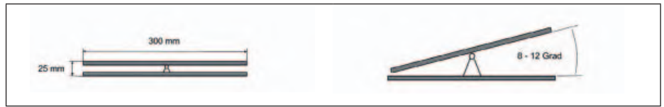
Abb. 16: Skizzen von Fußschaltern: (links) waagerechter Wippschalter für stehende oder kombinierte Arbeitsplätze (rechts) geneigtes Pedal für sitzende Tätigkeit
