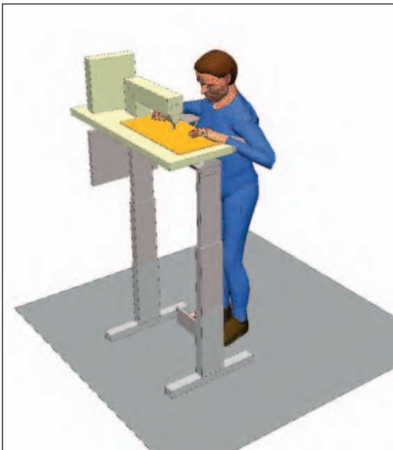
a) bei sehr hohen Genauigkeitsanforderungen (Sehabstand < 300 mm) → Tischhöhe 1400 mm
