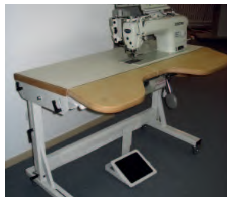
Abb. 2c: Nähmaschinengestelle mit Höhenverstellmöglichkeit mittels Handkurbel
