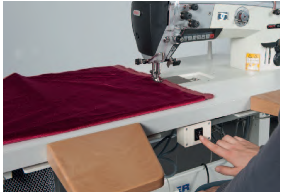
Abb. 2b: Bedienelemente der elektromechanischen Höhenverstellung
