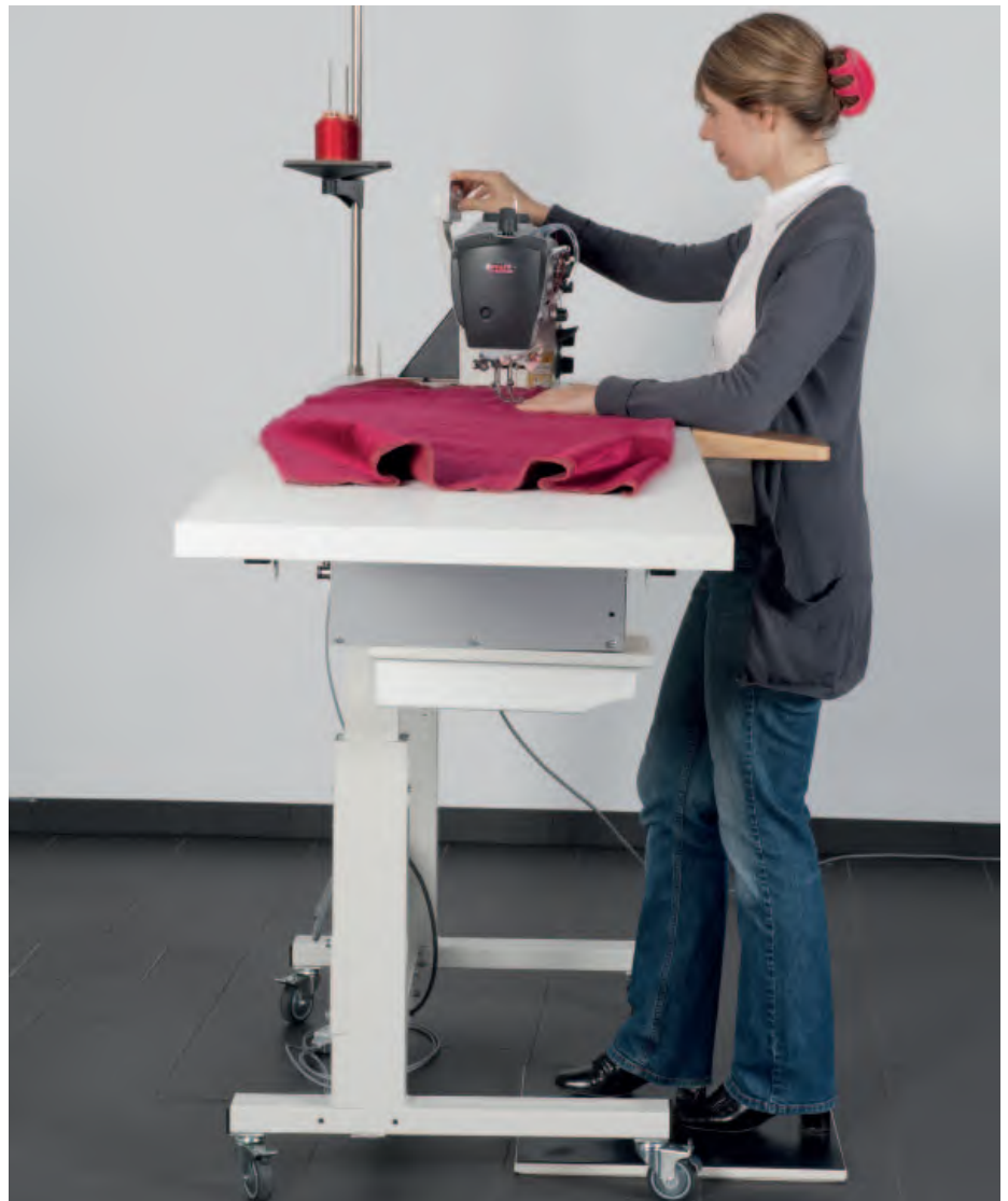
Abb. 19a: Sensormatte zur Fußbetätigung
