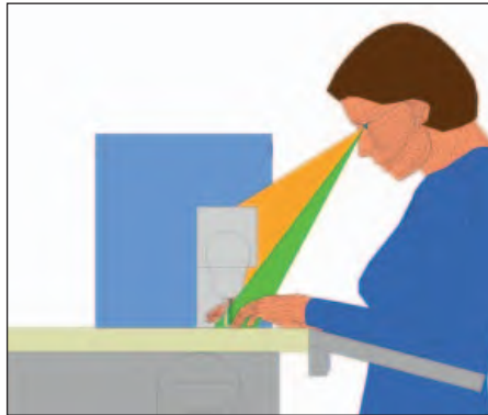
Abb. 4a: Eingeschränkte Einsehbarkeit des Näh- und Wirkbereichs, insbesondere hinter Nadel und Nähmaschine infolge Sichtfeldabdeckung durch Nähmaschinenarm
