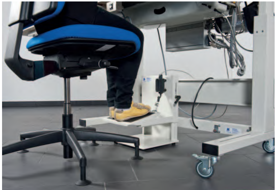
Abb. 9: Freier Beinraum: Alle störenden Maschinenelemente wurden nach außen verlegt.
