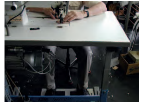
Abb. 29: Erweiterter Beinfreiraum; Sitzposition mittig unter der Nadel
