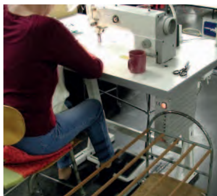
Abb. 21a und b: Anordnung von Stellteilen und Anzeigen; a) Steuerungskasten ungünstig unter der Tischplatte angebracht; b) auf Tischplatte besser einzusehen und zu erreichen.
