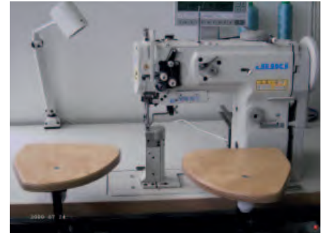
Abb. 15b: Zwei unterschiedlich höhenverstellbare und flexibel neigbare Armauflagen an einer Säulennähmaschine
