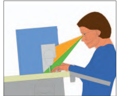
Abb. 4b: Verbesserte Einsehbarkeit durch geneigte Tischplatte
