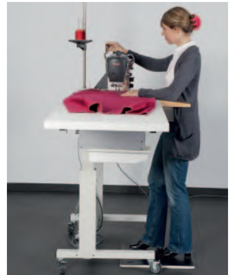
Abb. 2a: Näharbeitsplatz mit elektromechanischer Arbeitstischhöhenverstellung
