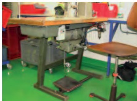
Abb. 7a und b: Negativbeispiele mit Einengung des Beinraumes unter dem Tisch durch Einbauten
