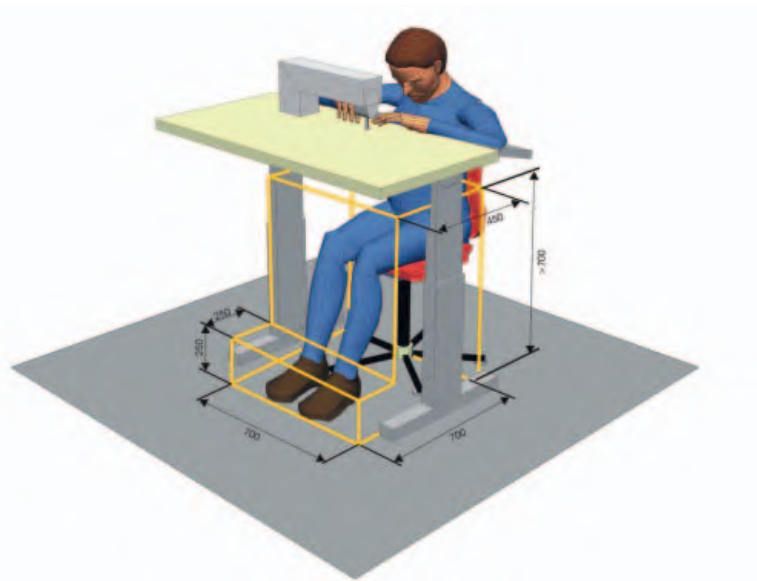
Abb. 6: Mindestmaße für Fuß- und Beinraum beim Sitznähbeitsplatz (* Bezugsebene für die Maßangaben ist die Tischvorderkante)
