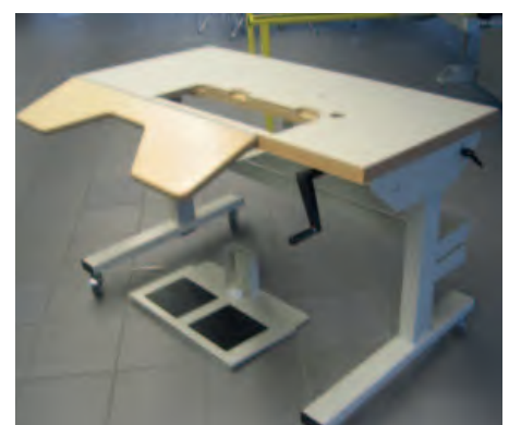
Abb. 2c: Nähmaschinengestelle mit Höhenverstellmöglichkeit mittels Handkurbel
