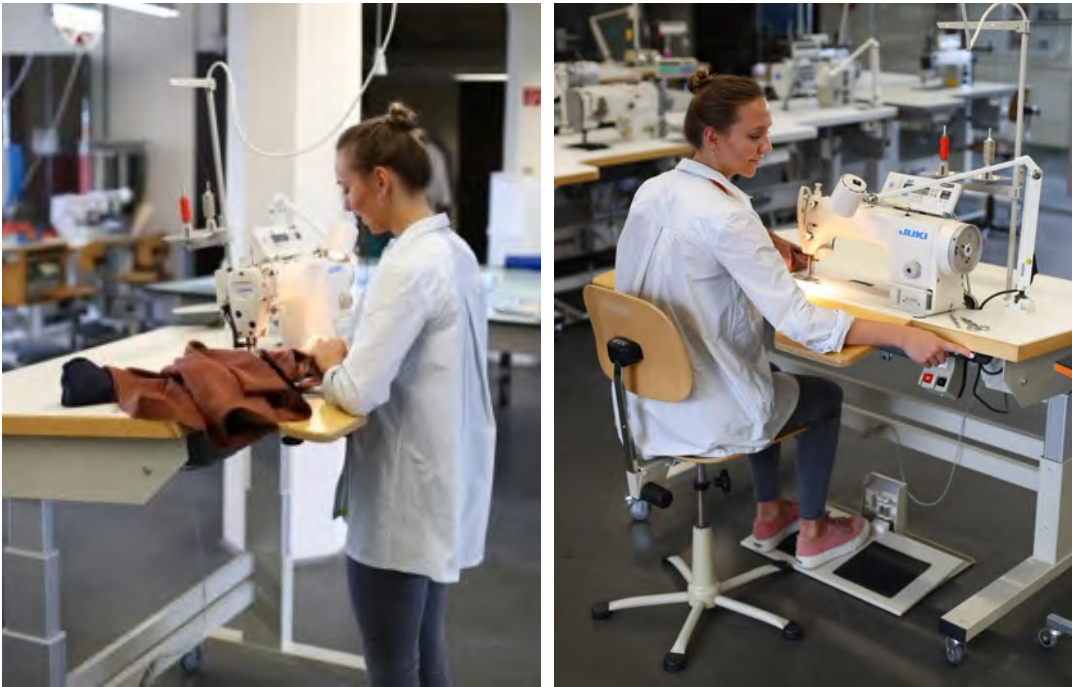
Abb. 2a Näharbeitsplatz mit elektromechanischer Arbeitstischhöhenverstellung
