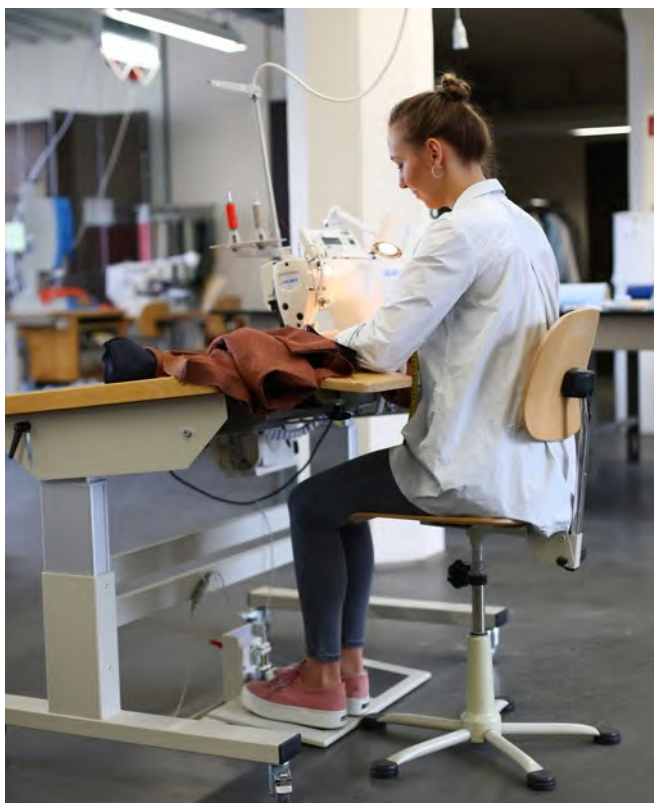
Abb. 5 a und 5 b Geneigte Tischplatte mit Armauflagen günstige Arbeitsposition und gute Einsehbarkeit
