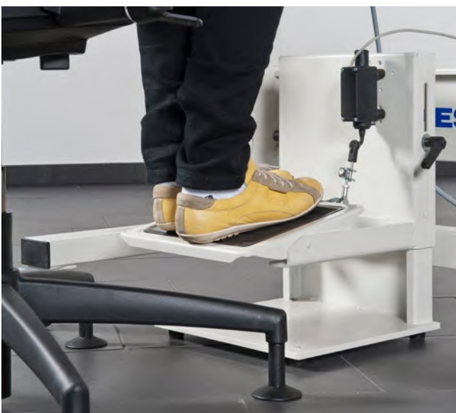
Abb. 15 Mobiler, höhenverstellbarer Fußschalter mit geneigter Trittplatte für Nähen im Sitzen
