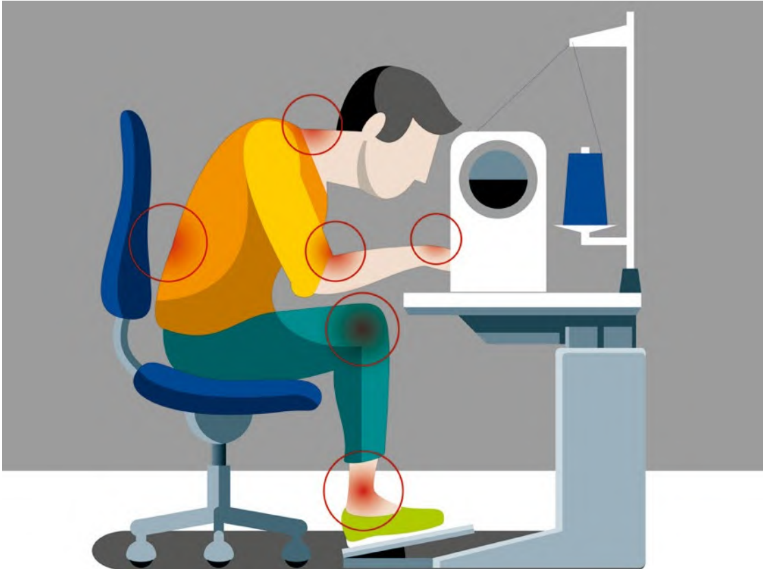
Abb. 1 Nicht-ergonomischer Näharbeitsplatz: Als Folge können Schulter-Nacken-Verspannungen, Kopfschmerzen, Wirbelsäulenbeschwerden, Schmerzen an Armen und Händen sowie im Fuß-Bein-Bereich auftreten.
