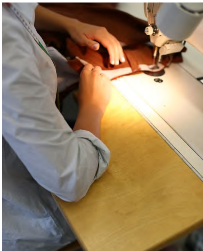
Abb. 5 a und 5 b Geneigte Tischplatte mit Armauflagen günstige Arbeitsposition und gute Einsehbarkeit
