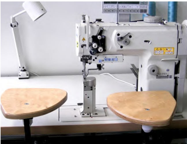
Abb. 13 b Zwei unterschiedlich höhenverstellbare und flexibel neigbare Armauflagen an einer Säulennähmaschine
