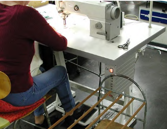
Abb. 19 a und b Anordnung von Stellteilen und Anzeigen; a) Steuerungskasten ungünstig unter der Tischplatte angebracht; b) auf Tischplatte besser einzusehen und zu erreichen.
