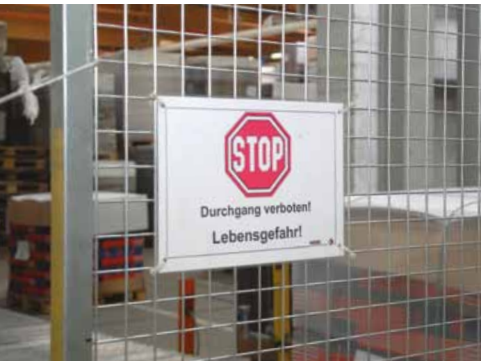
Die Bereiche, in denen Transferwagen mit sehr langen Anhaltewegen eingesetzt werden, müssen abgesichert sein, beispielsweise durch Zäune von mindestens 2 m Höhe.
