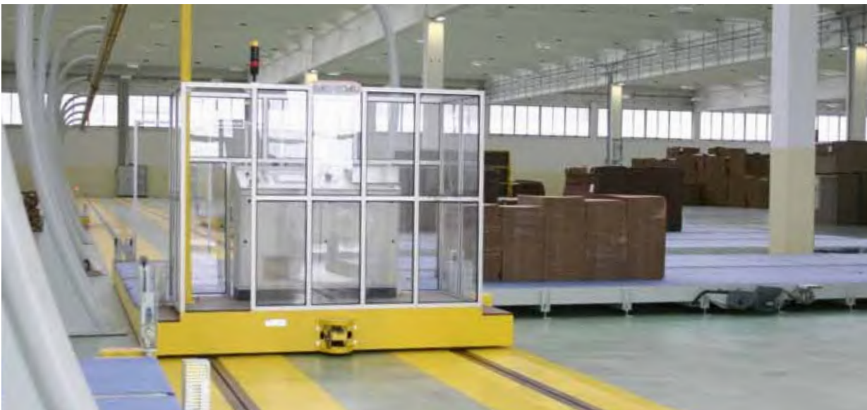
Optische oder akustische Signale weisen auf die Annäherung eines Transferwagens hin
