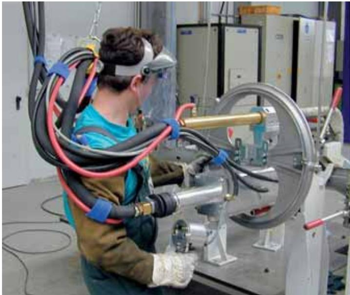
**Bild 22:** Beispiel für ungünstige Kabelführung
