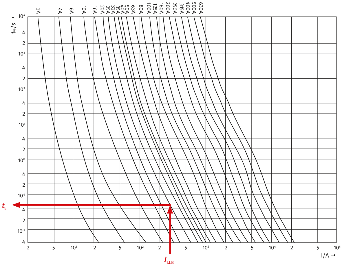
Abb. 4-3 Beispiel zur Ermittlung der Abschaltzeit der Überstromschutzeinrichtung
