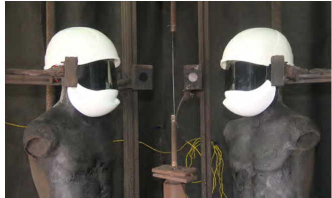
Abb. A 2-2 ATPV-Testaufbau
