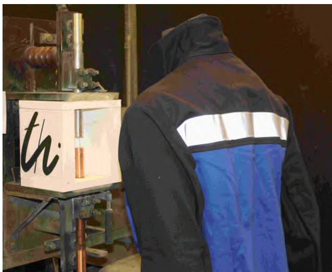
Abb. A 2-1 Prüfaufbau Box-Test Verfahren
