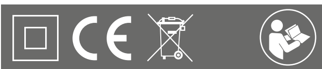
Abb. 19 Typenschild mit Symbol Schutzklasse II → Schutzisolierung
