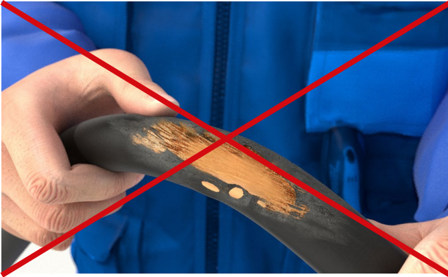
Abb. 12 Beschädigte elektrische Leitung
