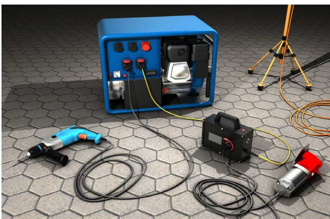
Abb. 15 Beispiel für den Betrieb eines Stromerzeugers bei erhöhter elektrischer Gefährdung.
