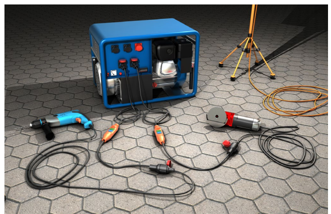
Abb. 16 Jedem Verbrauchsmittel ist eine PRCD vorgeschaltet.
