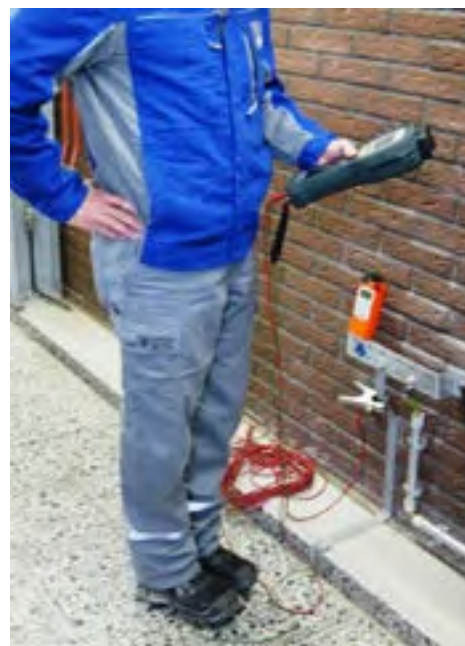
Abb. 35 Durchführung der Fußbodenmessung
