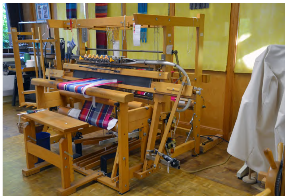
Abb. 13.9.2 Mehrschäftiger Webstuhl mit pneumatischer Unterstützung
