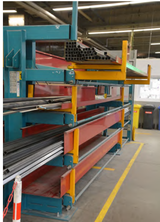
Abb. 13.2.3 Lagerregal für Lang- und Rundmaterial
