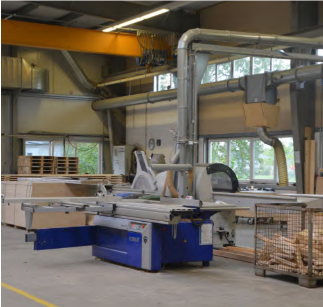
Abb. 13.1.2 Formatkreissäge einer Schreinerei
