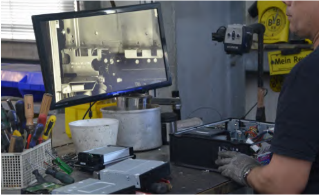
Abb. 13.8.4 Zerlegearbeitsplatz für Elektro-/Elektronikschrott mit einem optischen Unterstützungssystem
