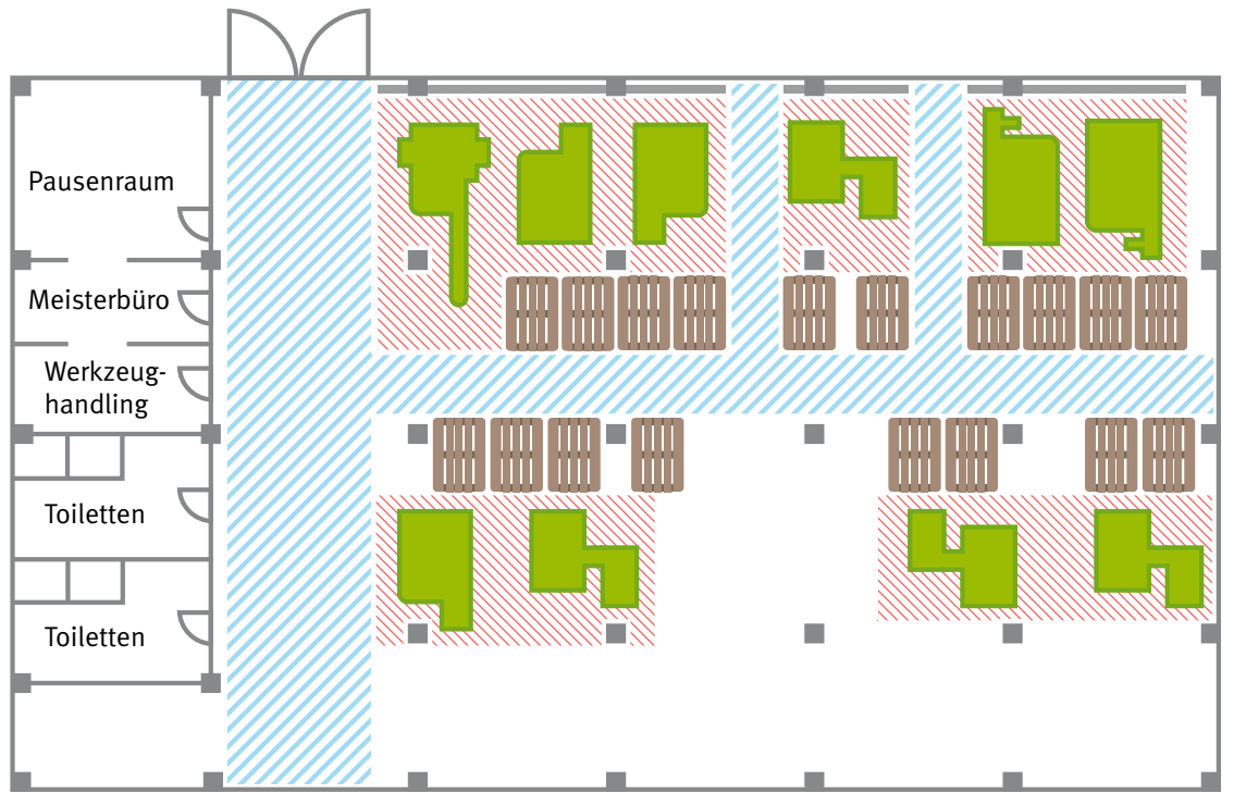
Abb. 2.4 Feinplanung mit detaillierter Maschinenpositionierung, optimierten Verkehrswegen etc.
