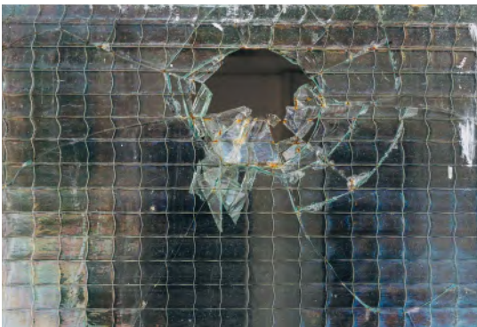
Abb. 6.2 Drahtglas mit Glasbruch
