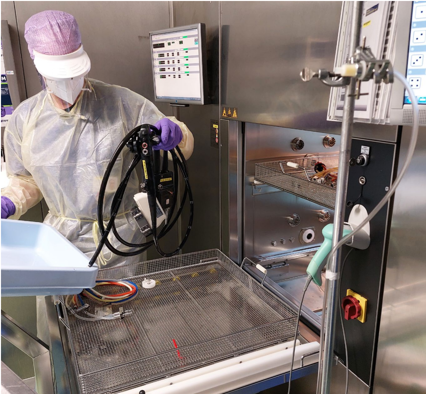
Abb. 9 Beschickung eines Reinigungs- und Desinfektionsgerätes für Endoskope (RDG-E), hier exemplarisch in einer AEMP
