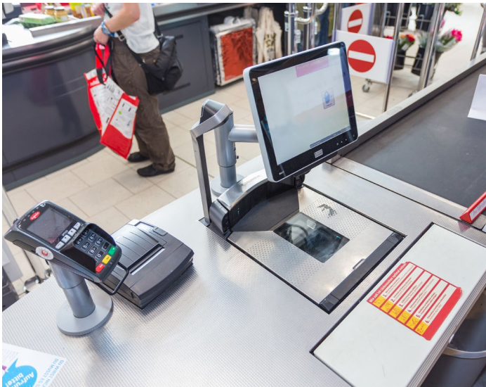
Abb. 5 Die Einzugsstelle am Ende des Bandförderers muss gesichert sein.
