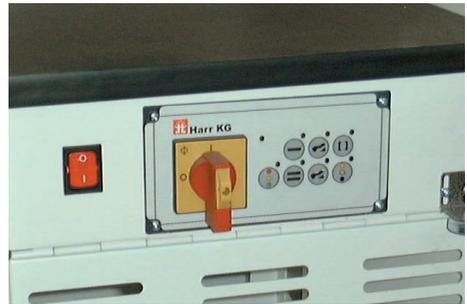
Bild 3: Notbefehleinrichtung
