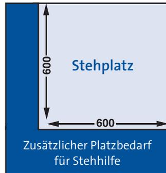
Bild 2: Platzbedarf in der Kassenbox (Maße in mm)
