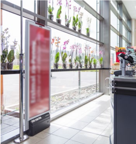
Abb. 10 Warenausgangs- antenne am Ausgang
