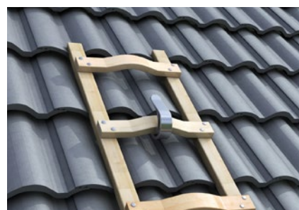
Abb. 66 Einhängen der Dachauflegeleiter
