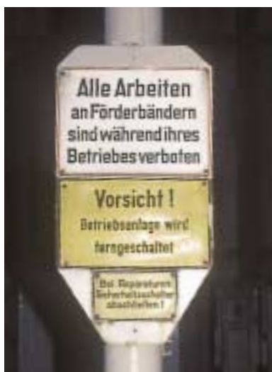
Abb. 45: Hinweisschild an ferngesteuerter Bandanlage
