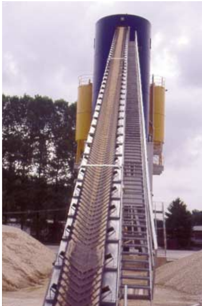
Abb. 23: Treppenaufgang neben einem Steilband
