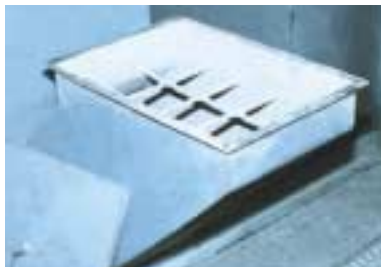
Abb. 38: Einwurffrichter mit Rostabdeckung
