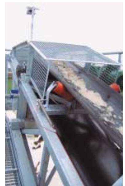
Abb. 5: Schutz-einrichtung an der Kopftrommel
