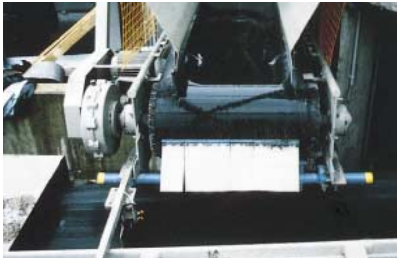
Abb. 24: Federbelasteter Lamellenabstreifer an einer Abwurfstelle
