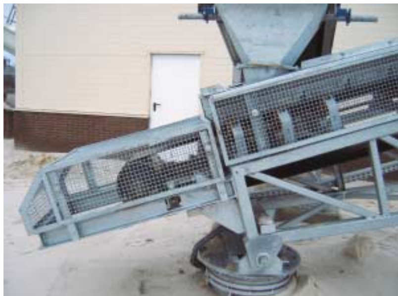
Abb. 6: Schutzeinrichtung an der Umlenktrommel
