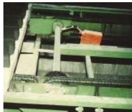
Abb. 35: Allseitige Verdeckung von Transportketten
