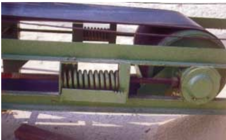
Abb. 8: Winkel als Füllstück an der Spanntrommel
