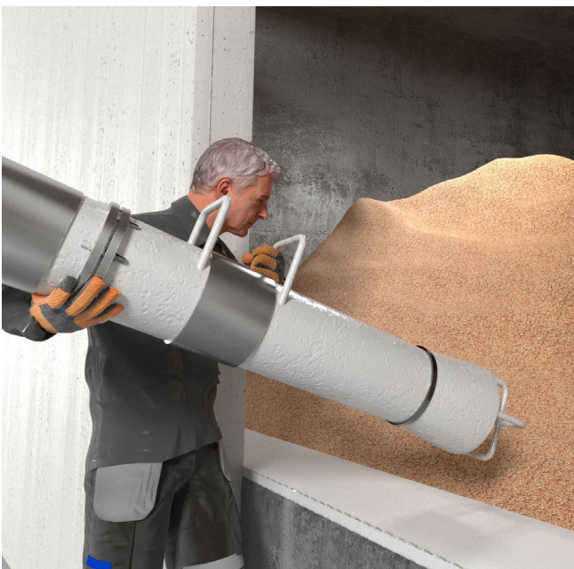
Abb. 37 Einlassöffnung eines Saugrohres durch Stäbe begrenzt
