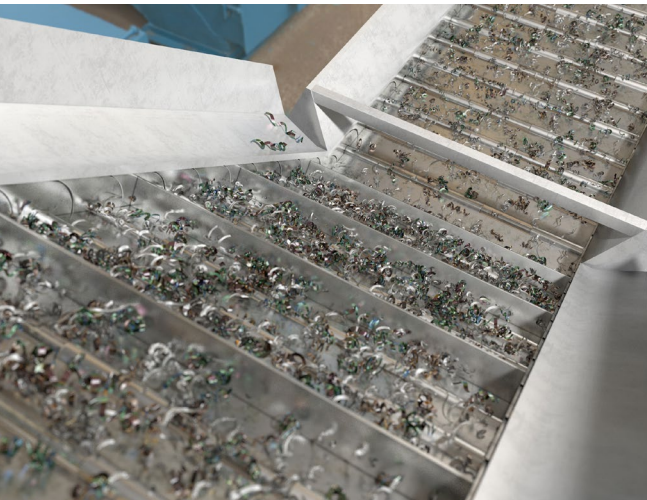
Abb. 3 Scharnierbandförderer als Späneförderer
