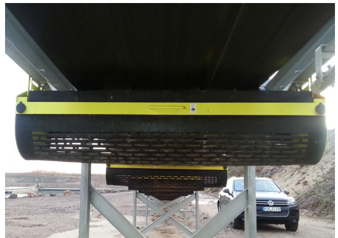
Abb. 21 Schutzkorb als feststehende trennende Schutzeinrichtung für Untergurtrollen
