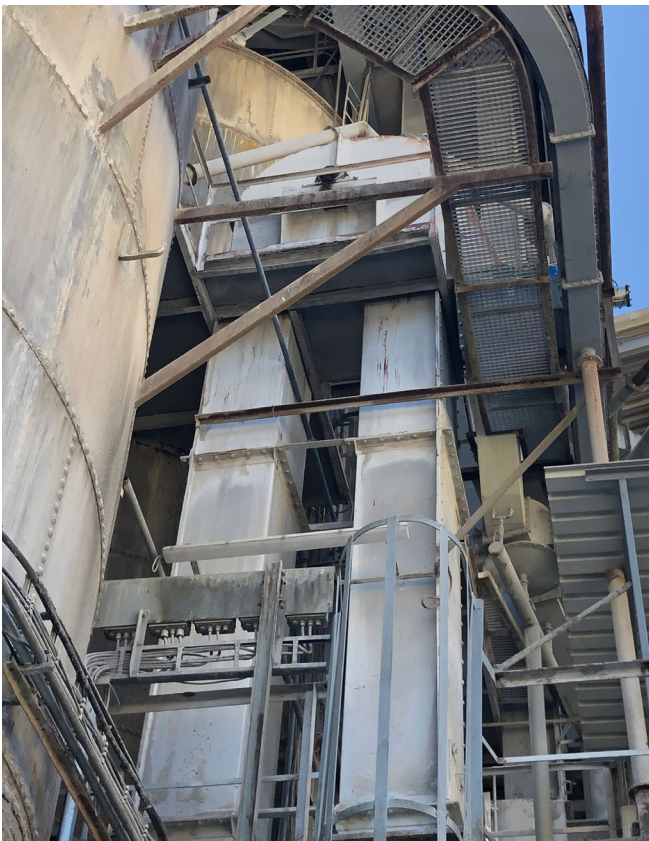
Abb. 34 Becherwerke mit Bühne an den Becherwerksköpfen
