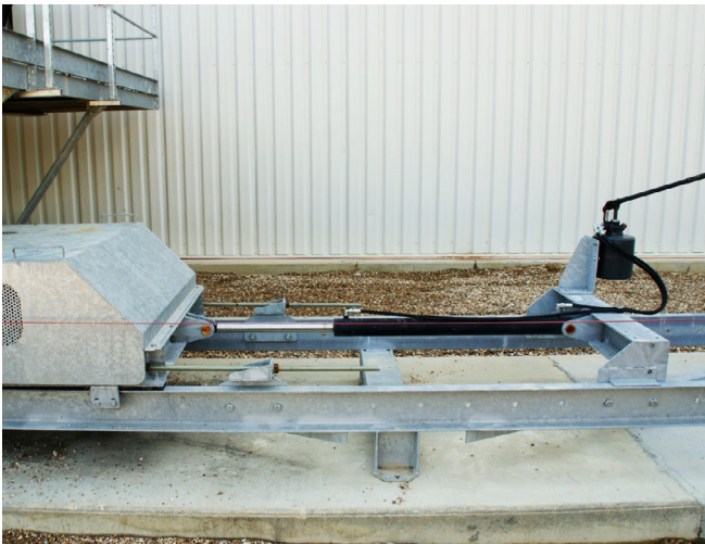
Abb. 22 Spanneinrichtung mit Verstellmöglichkeit von außen
