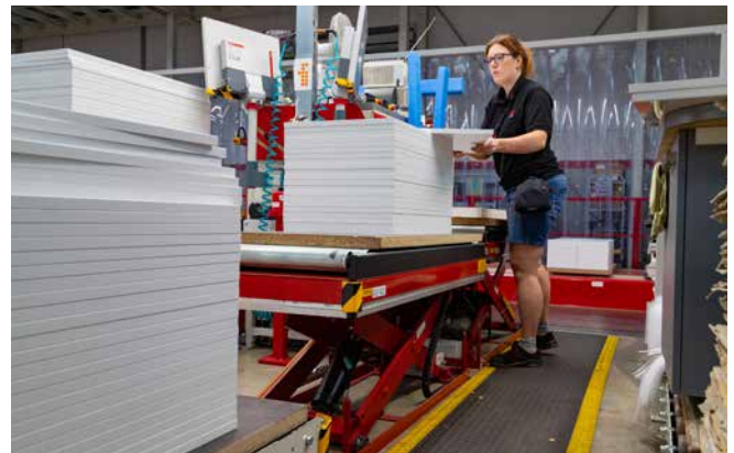
Abb. 6 Scherenhubtisch zur Anpassung der Arbeitshöhe
