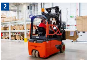
2 Niemals ohne Sicht fahren. Beim Transport hoher Lasten ausnahmsweise rückwärts fahren oder sich einweisen lassen.
