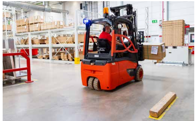
Abb. 19 Niemals ohne Sicht fahren. Beim Transport hoher Lasten ausnahmsweise rückwärts fahren oder Einweiser zu Hilfe nehmen.
