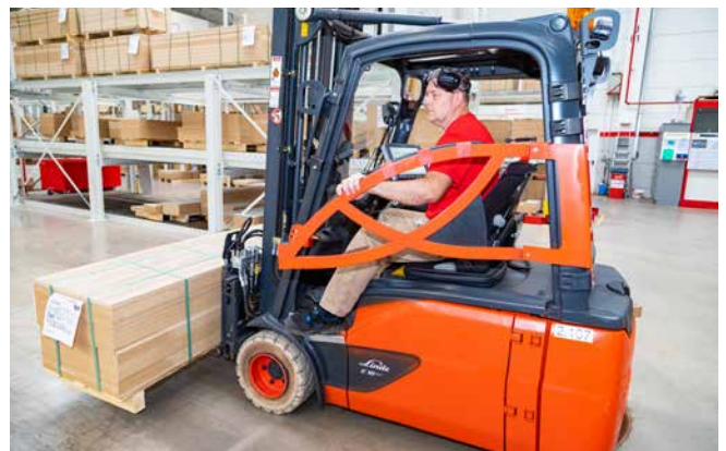
Abb. 24 Gabelstapler erst verlassen, wenn der Antrieb stillgesetzt, die Feststellbremse angezogen, die Gabeln auf den Boden abgesenkt und der Schlüssel abgezogen ist.
