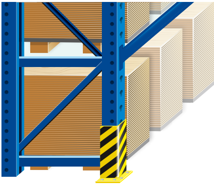
Abb. 65 Anfahrerschutz vor der Eckstütze eines Regals (Anfahrerenergieaufnahme mindestens 400 Nm)
