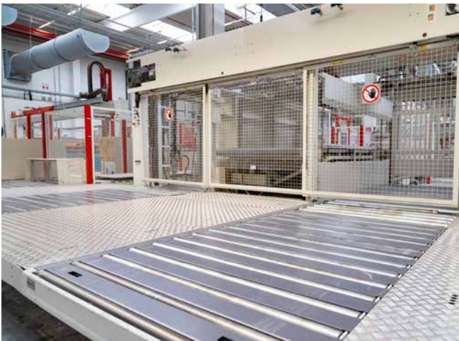
Abb. 14 Arbeitsbereich mit rutschfesten Standflächen und ausgekleideten Rollengängen
