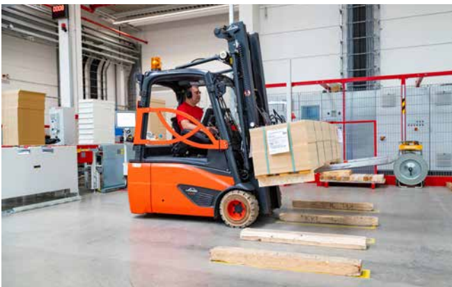
Abb. 18 Last am Gabelrücken anlegen, Hubmast nach hinten neigen. Gabelzinken gleichmäßig belasten, in niedriger Stellung verfahren
