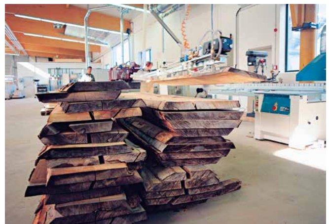
Abb. 48 Vakuumheber für Schnittholz
