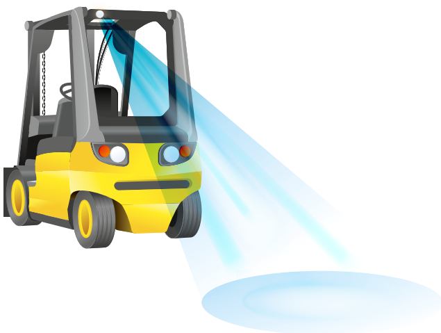
Abb. 41 Stapler mit optischer Fahrweg-Warnerichtung
