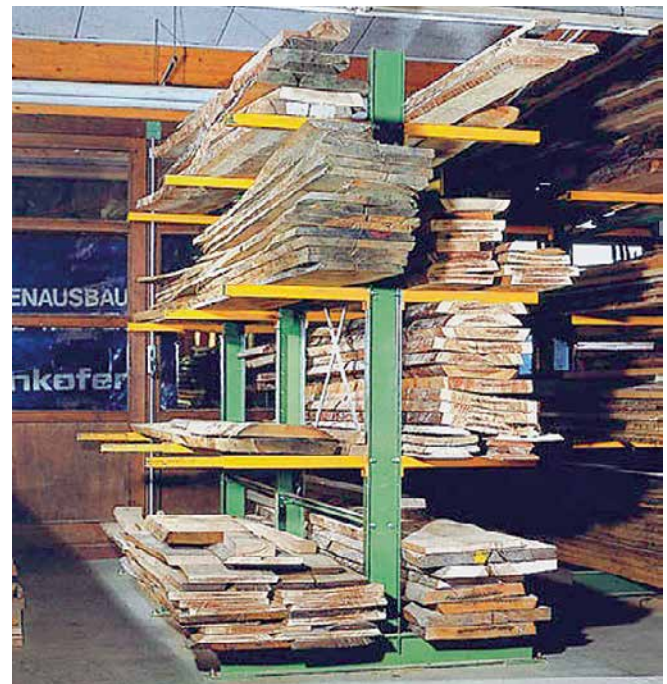
Abb. 64 Kragarmregal (mit Teleskoparmen für Schnittholz)
