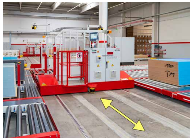
Abb. 84 Querverschiebewagen mit Laserscanner
