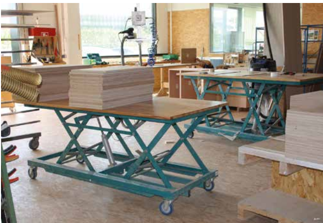
Abb. 34 Transporthubwagen mit Höhenverstellung
