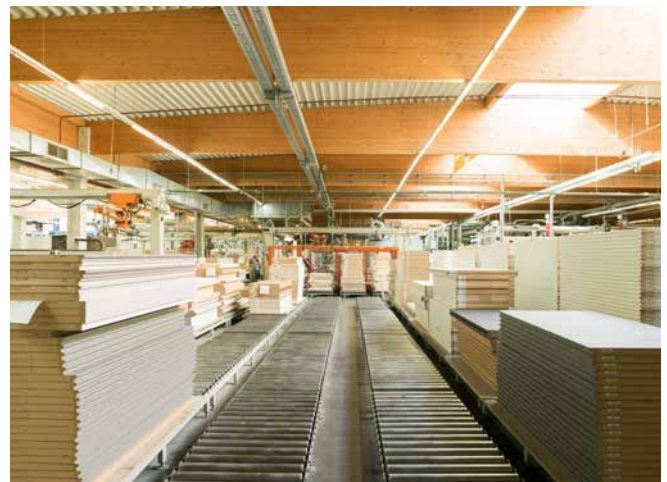
Abb. 9 Anlieferung der Werkstücke über Rollenbahnen
