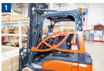
1 Fahrerrückhalteinrichtung (hier: Bügeltür) bei jeder Fahrt benutzen.
