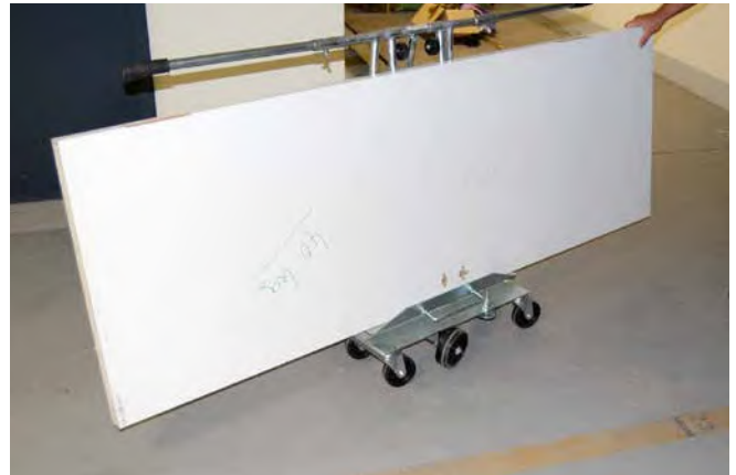
Abb. 31 Plattenschwenkwagen – Platte senkrecht in Transportposition
