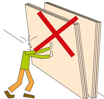
Abb. 51 Unzulässiges „Blättern“ in einem Plattenlager
