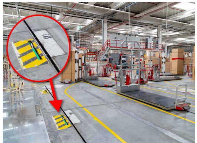
Abb. 89 Auskoppelstelle des Schleppkettenförderers
