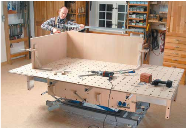
Abb. 11 Höhenverstellbarer und verfahrbarer Montagetisch mit Energieanschluss
