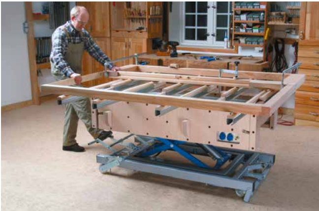
Abb. 33 Montagetisch, höhenverstellbar, auch zum Transport geeignet
