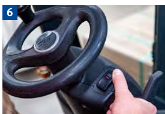
6 Vor Verlassen des Flurförderzeugs Feststellbremse anziehen und Gabeln absenken. Auf geneigten Flächen zusätzlich durch Unterlegkeile das Wegrollen verhindern.
