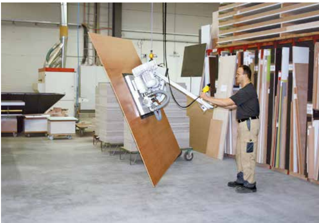
Abb. 46 Vakuum-Hebegerät für das Plattenhandling
