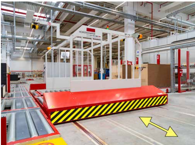
Abb. 87 Absicherung im Bodenbereich durch Bumper
