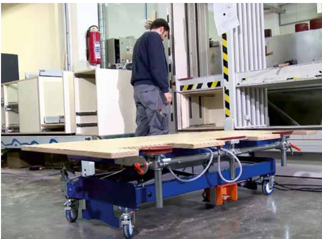
Abb. 7 Fahrbarer Bestücktisch zur Handhabung von großen, schweren Werkstücken
