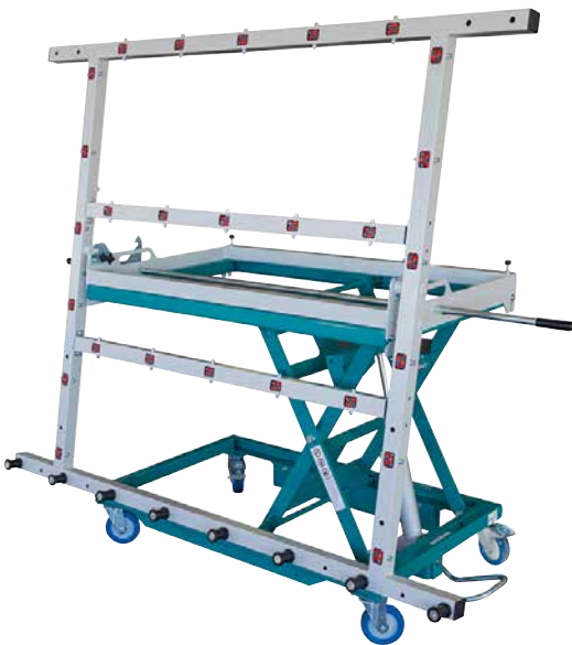
Abb. 30 Entnahme aus dem senkrechten Plattenlager, Kippen der Platte und waagrechte Zuführung auf benötigter Höhe, z. B. an einer Formatkreissäge
