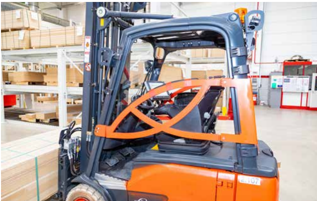
Abb. 17 Fahrerrückhalteeinrichtung (hier: Bügeltür) bei jeder Fahrt benutzen
