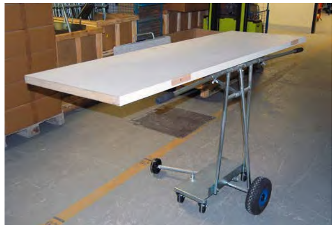
Abb. 32 Plattenschwenkwagen – Platte waagrecht geschwenkt
