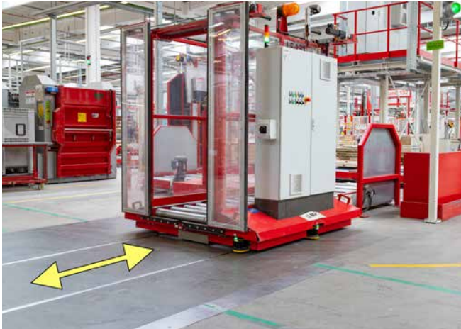
Abb. 86 Längsverschiebewagen mit Laserscanner
