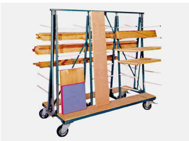
Abb. 26 Durch Plattentransportwagen entfällt manuelles Heben und Tragen
