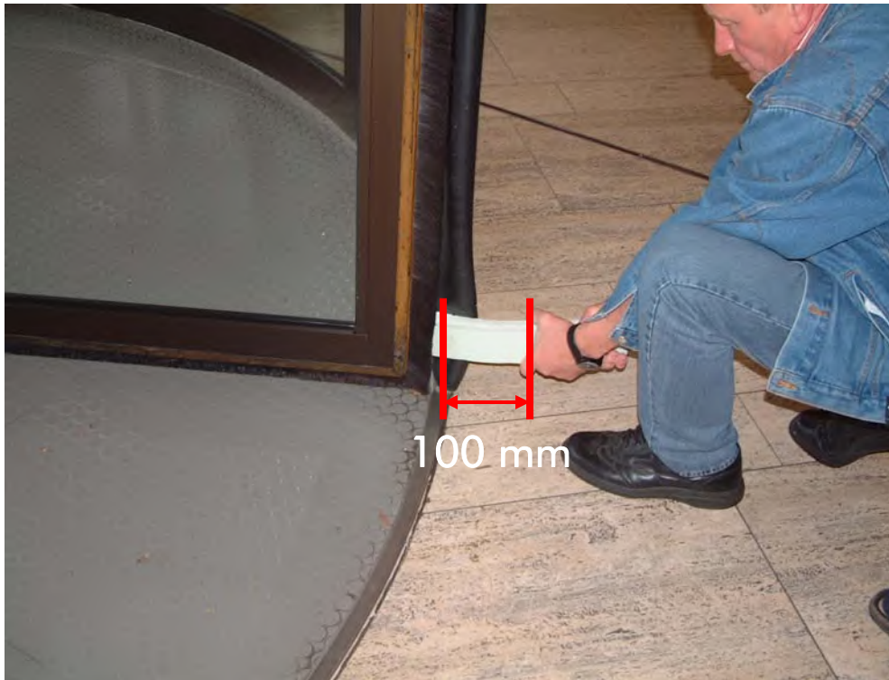
Abbildung 4: Richtige Anwendung, kein Bruch des Styrodurkörpers. Die Scherkraft des Türflügels ist kleiner als 105 N.
