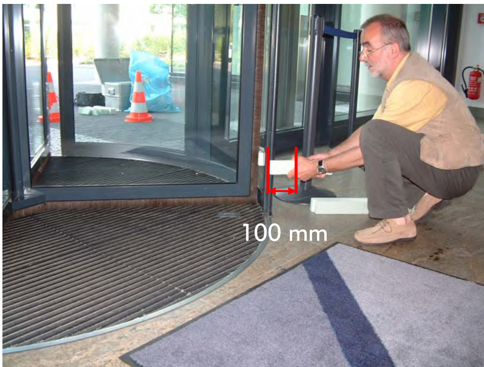
Abbildung 3: Richtige Anwendung, Bruch des Styrodurkörpers. Die Scherkraft des Türflügels ist größer als 105 N.
