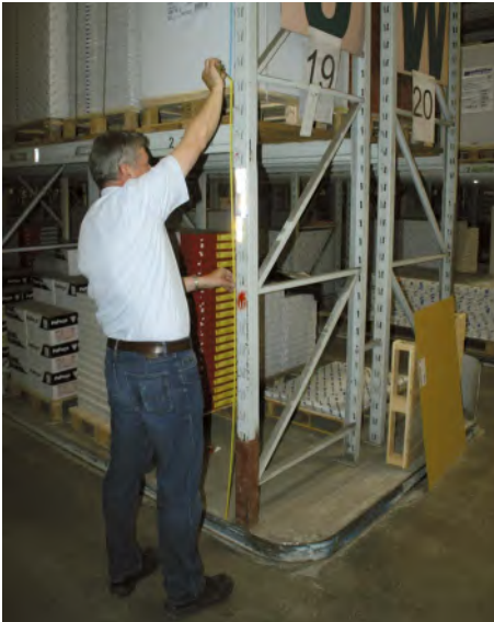
Abb. 6 Überprüfung der Fachhöhe
