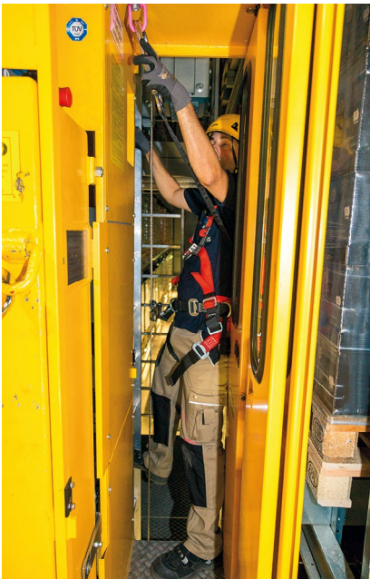
Abb. 12 Sichern am Anschlagpunkt im Notsteuerstand vor dem Lösen des Auffanggerätes
