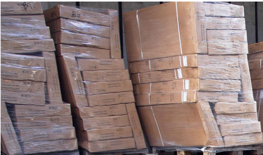
Abb. 1 Verschobene Ladung bei unzureichender Stretchesicherung
