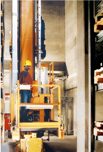
Abb. 9 Notsteuerstand auf dem Lastaufnahmemittel
