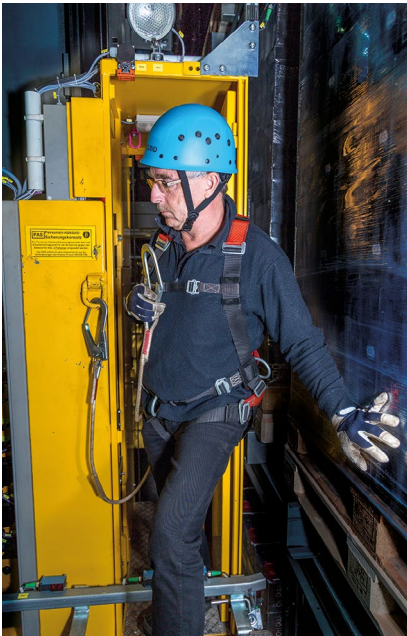
Abb. 7 Übergang vom Notsteuerstand zum Lastaufnahmemittel des Regalbediengerätes
