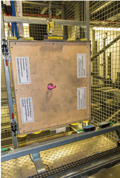
Abb. 15 Einfahrwagen auf dem Lastaufnahmemittel mitgeführt
