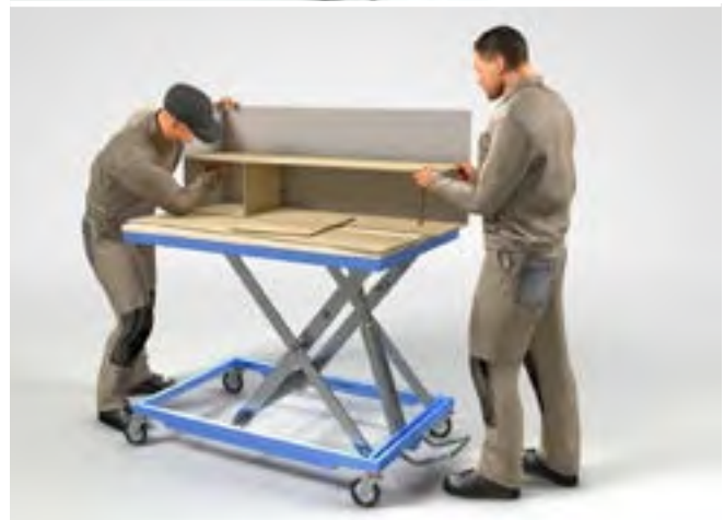
Abb. 19 Arbeiten in aufrechter Körperhaltung ohne einen Haltungswechsel durch drehbare Haltevorrichtung oder höhenverstellbaren Montagetisch
