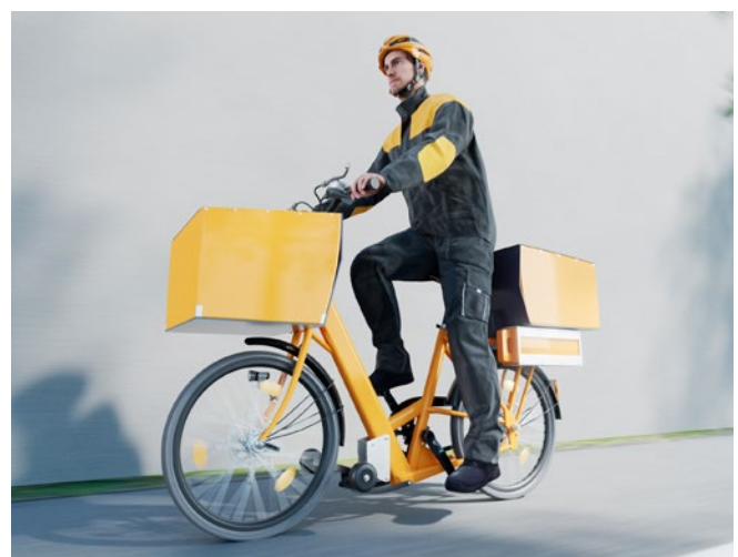
Abb. 26 Die Nutzung eines Lastenrades mit elektromotorischer Tretunterstützung kann bei Zustellertätigkeiten, die körperliche Beanspruchung bei der Körperfortbewegung verringern.
