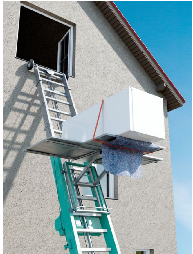
Abb. 25 Der Einsatz eines Anlegeaufzugs vermeidet Ganzkörperkräfte beim Transport schwerer Möbelstücke über enge Treppenhäuser.
