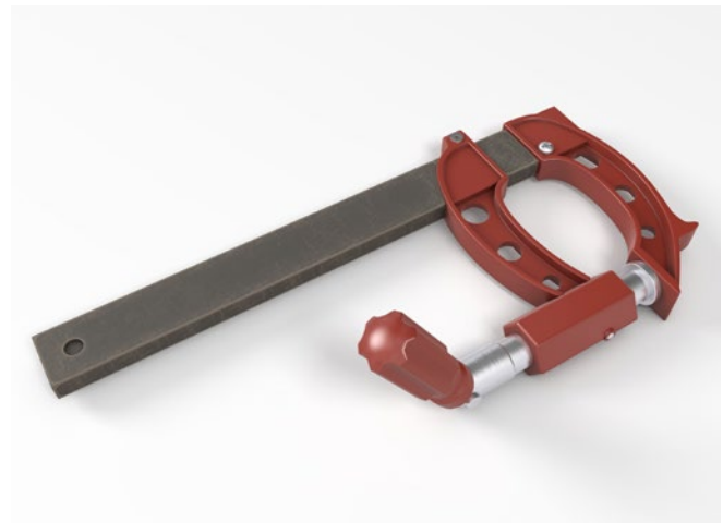
Abb. 30 Schraubzwingen mit optimierter Hebelwirkung verringern die erforderliche Handkraft
