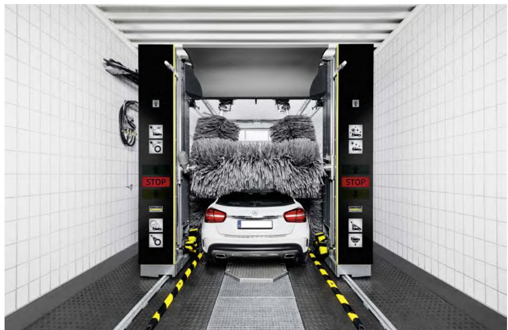
Abb. 4 Portalwaschanlage mit farblicher Kennzeichnung der Radführungen
