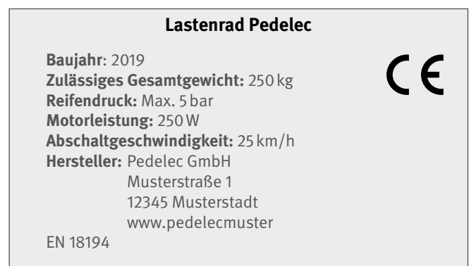
Abb. 5 Beispielhaftes Typenschild für ein Lastenrad mit elektromotorischer Tretunterstützung
