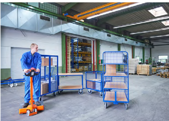
Abb. 10 Routenzug mit Stehsclepper und verschiedenen Anhängerformen
