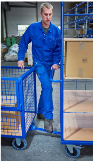
Abb. 22 Quetschgefahr beim Ankoppeln von Routenzügen
