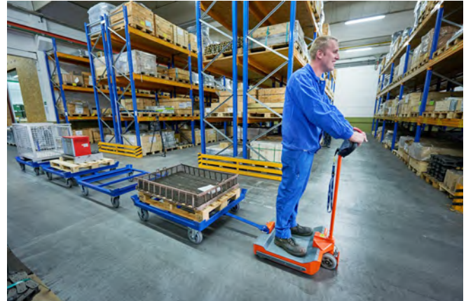
Abb. 2 Routenzug mit Stehschlepper und Palettenfahrrahmen
