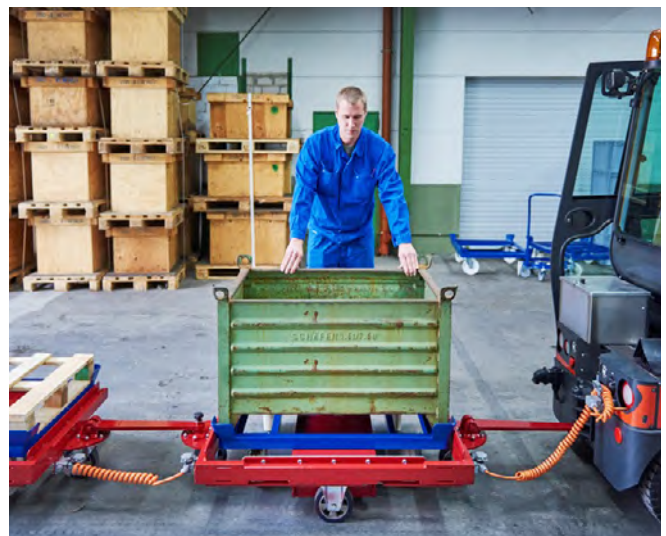
Abb. 20 Einschieben von Bodenroller in den Routenzug
