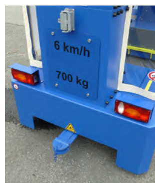
Abb. 24 Rückleuchte für Routenzüge
