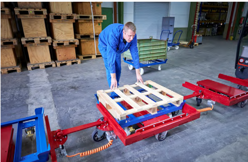
Abb. 8 Ergonomische Belastung beim Bestücken von Routenzügen
