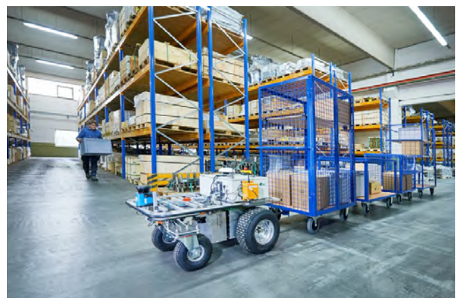
Abb. 4 Routenzug mit FTS und Regalwagen
