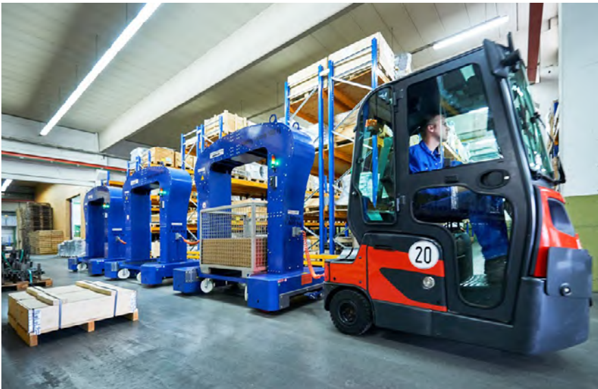
Abb. 1 Routenzug mit Sitzschlepper und Anhänger U-Frame
