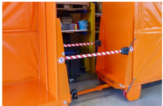
Abb. 25 Durchtrittssicherung bei Routenzügen
