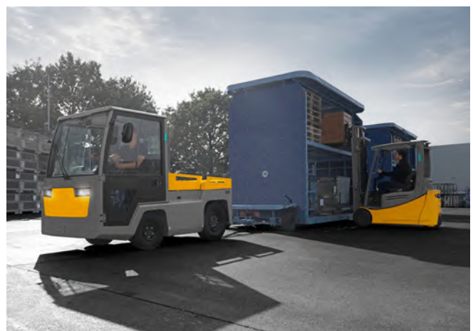
Abb. 12 Auf Außeneinsatz angepasster Schlepper im Einsatz
