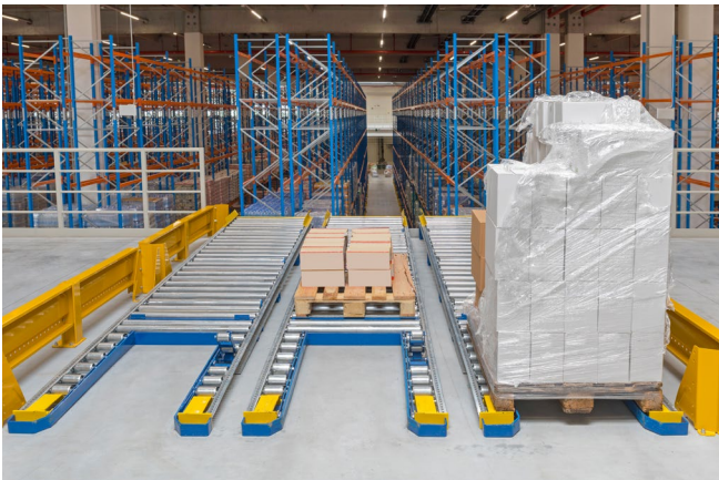
Abb. 4 Schwerkraftrollenbahnen als Puffer im Waren- ausgang
