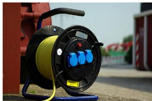
Abb. 22 Für Baustellen geeigneter Leitungsroller
